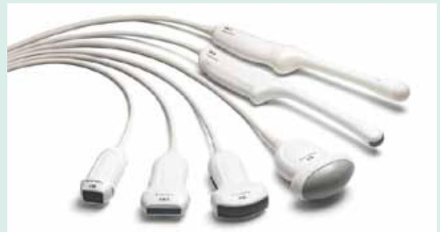
Четыре порта для датчиков позволяют быстро переключать систему ClearVue 650 и использовать в работе весь набор датчиков: C5-2, C9-4v, V6-2, 3D9-3v, L12-4 и S4-1.
