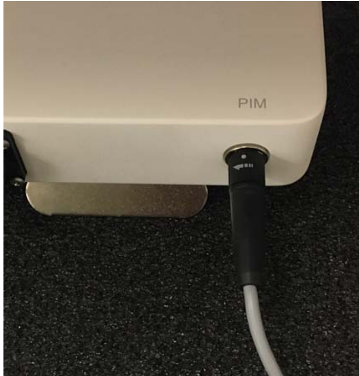
Рисунок 2. Подключение устройства FM-PIM к главной системе
