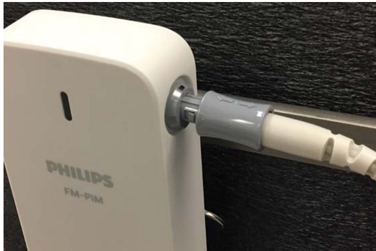
Рисунок 3. Подключение проводника к устройству FM-PIM
